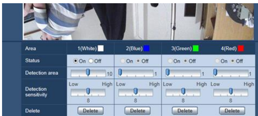
Obr. 2 Video detekcia pohybu – softvér s možnosťou nastavenia dvoch parametrov a viacerých detekčných zón (Zdroj: autori)
